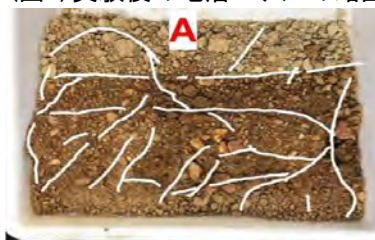
A:日本原層と高倉層 B:高倉層のみ (写真2)モデルのひび割れ
