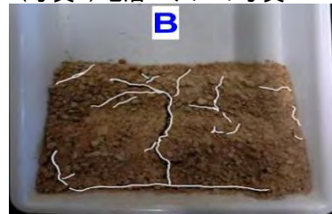
A:日本原層と高倉層 B:高倉層のみ (写真2)モデルのひび割れ
