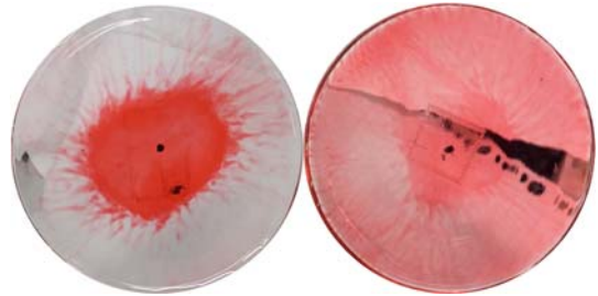
(左が粘度 1.5\text{mPa}\cdot\text{s} , 右が粘度 2.0\text{mPa}\cdot\text{s} )
