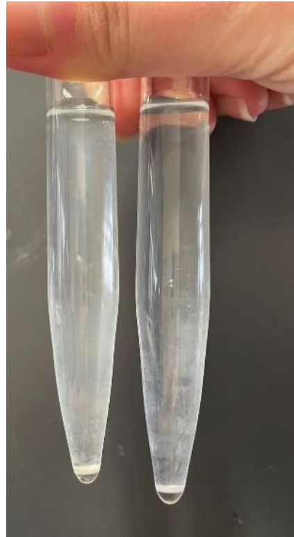
図8 バリウムによる沈殿と上澄み液
