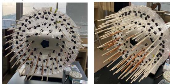
図6 ローテーターを用いた乾燥方法
