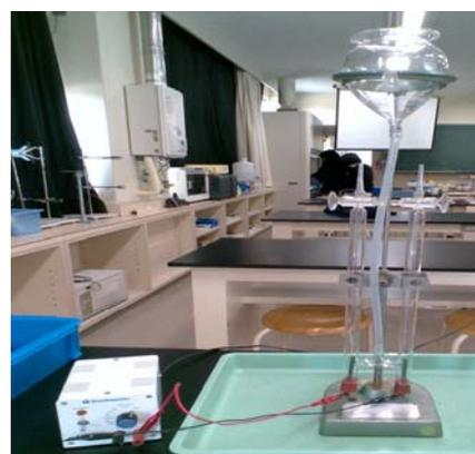
写真 2. ホフマン式電解装置
