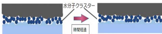
図 9 : 水がある場合の接地面のモデル
