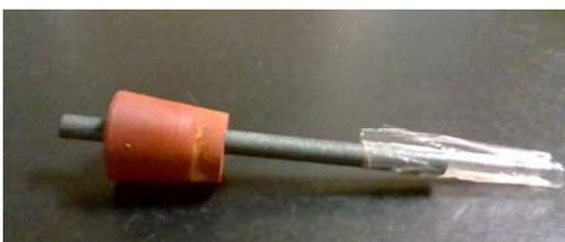
写真3. 半透膜を巻いて電気分解に利用した炭素棒
