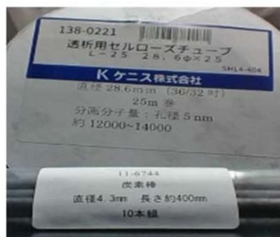
写真 1. 使用した炭素棒および半透膜
