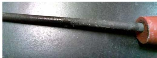
写真4. 半透膜を巻かずに電気分解に利用した炭素棒
