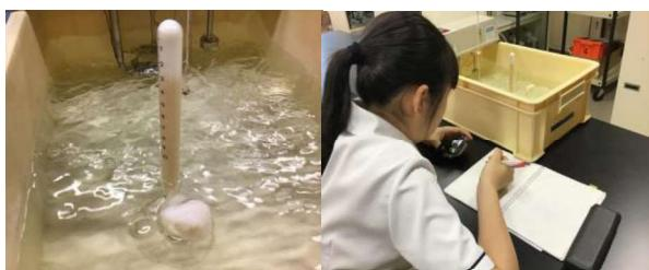
図5 実験1の様子。左側の写真が混合液を入れ、40°Cのお湯についている状態のキューネ発酵管の様子で、右側の写真が発生した気体の発生量を1分ごとに測定している様子。
