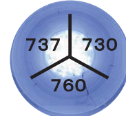
LED照明が水槽内を均一に照らしているか照度計で確認
