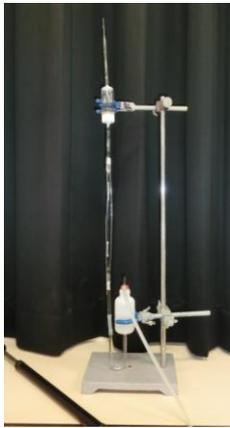
図3 自作した粘度計
