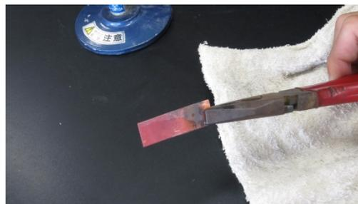
作成した亜酸化銅  $\text{Cu}_2\text{O}$  板 (赤い部分)
