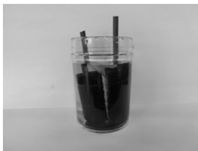
図2 製作した炭素電池
